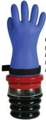
G100-ES (con guante de bajo voltaje inflado listo para su inspección)
